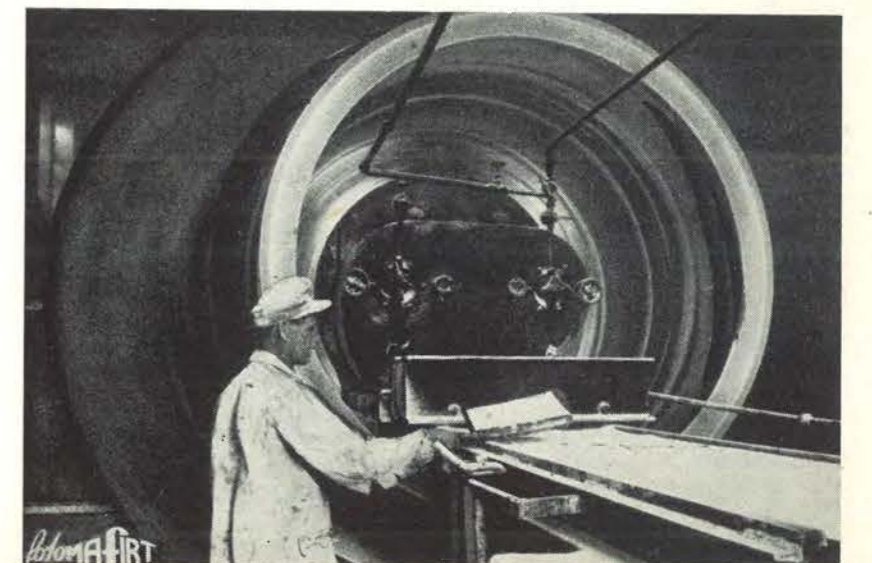
19. ábra. Kalcináló kemence tüzelőfej
