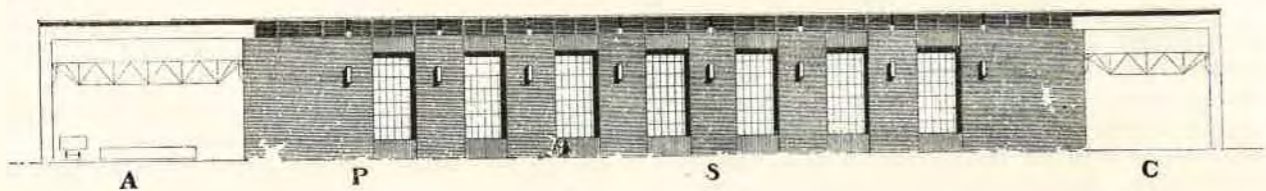
7. ábra. A = Anyagtároló P = Kúpoló S = Magformázás C = Formaszekrénytároló
