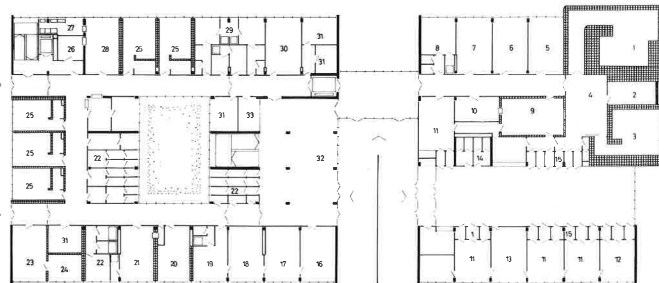
Földszinti alaprajz 1. Kobalt 60 besugárzó. 2. Gépház. 3. Caesium 137 besugárzó. 4. Vezérlő. 5. Fizikus. 6. Asszisztens. 7. Orvos. 8. Öltöző. 9. Röntgen. 10. Foto. 11. Vizsgálók. 12. Főorvos. 13. Nyilvántartás. 14. Eü. helyiségek. 15. Vétközők. 16. Váró. 17. Mérőlabor (cirkulográf). 18. Mérőlabor. (scintikart). 19. Orvos. 20. Kezelő. 21. Osztólabor. 22. Eü. helyiségek. 23. Dekontamináló. 24. Aktív hulladék tároló. 25. Aktív betegszobák. 26. Tálaló. 27. Mosogató. 28. Étköző. 29. Eü. zsilip. 30. Osztály iroda. 31. Raktár. 32. Előcsarnok, váró. 33. Eligazító
