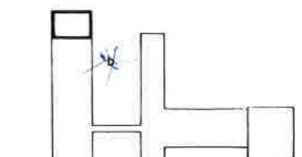
4a ábra. Csepel Vas és Féművek izotóp laboratórium, neutron generátor blokk Alaprajz, m = 1:400 a) Mobil védelem, b) Diszpozíciós vázlat, 1. Generátor helyiség, 2. Vezénylő, 3. Dolgozó, 4. Laboratóriumi helyiségek. A—A metszet m = 1:400
