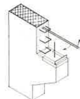
vb keret kialakítása darukonzolánál
