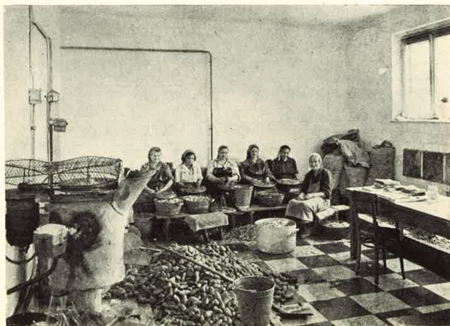
17. ábra. Zöldségelőkészítő; helytelenül egy helyiségben történik a kézi és gépi előkészítés
